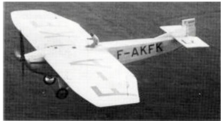
Le Farman 1000 en juillet 1932. Le pilote doit décoller assis sur la carlingue (il dispose d'un manche spécial), puis se glisser à l'intérieur du cylindre étanche (Source M.A.E.)
