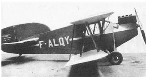
Ultime avion de tourisme de la SAEAW (Société Anonyme des Etablissements Aéronautiques Weymann), il fut conçu par l'ingénieur Delasalle. Biplace côte à côte à cabine fermée, il est intégralement réalisé en bois. D'une envergure de 10m, il avait fait l'objet d'une construction particulièrement solide afin de recevoir n'importe quel moteur de 95ch à 150ch, d'où son surnom "de Ford de l'Air".
