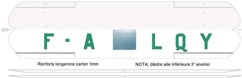
NOTA: Les longerons sont à positionner au 1/3 avant de la corde des ailes
