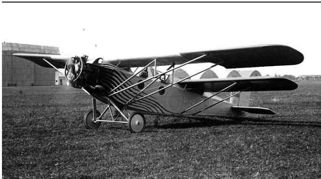
Le Triavion, créé par Joseph Albessard, est né de l'idée qu'en multipliant les points d'appui dans l'air, on accroissait sensiblement la stabilité, donc la sécurité. C'est du fractionnement de la surface portante en trois parties que le Triavion tire son nom.
