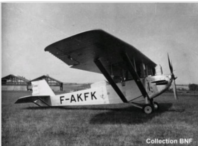
Le Farman F 1001 était un avion expérimental issu du F 1000 qui a été spécialement conçu pour battre le record d'altitude. Il était équipé d'une cabine pressurisée pour le pilote et était propulsé par un moteur en ligne Farman 12 Wiars de 540 CV.
