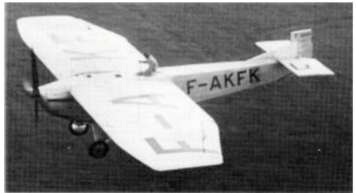
**Le Farman 1000 en juillet 1932. Le pilote doit decoller assis sur la carlingue (il dispose d'un manche spécial), puis se glisser à l'intérieur du cylindre étanche (Source M.A.E.)**
